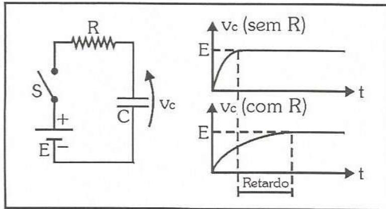
Ligando um resistor em série com o capacitor, pode-se retardar o tempo de carga, fazendo com que a tensão entre os seus terminais cresça mais lentamente. O produto RC resulta na grandeza "tempo" (segundo). Esse produto é chamado constante de tempo:  $T = R.C$
