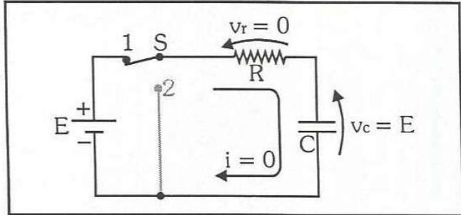
Ao mudar a chave  $S$  para a posição 2 no instante  $t = 0$ , a fonte de alimentação é desligada, ficando o circuito RC em curto.
