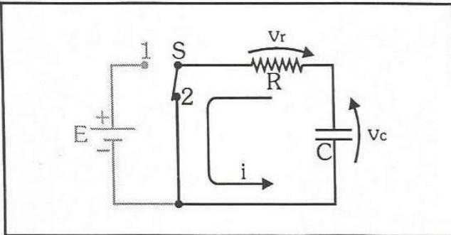
Nesse caso, o capacitor comporta-se como uma **fonte de tensão**, cuja capacidade de fornecimento de corrente é limitada pelo tempo de descarga.
