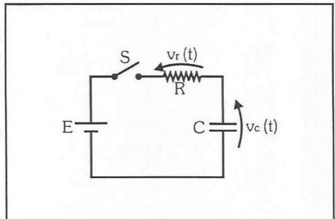
A corrente que flui no circuito durante a carga do capacitor pode ser determinada aplicando-se a Primeira Lei de Ohm no resistor **R**:
